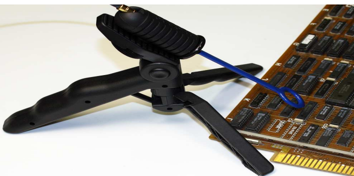
Einsatz des beiliegenden Ministativs zur Sondenfixierung
