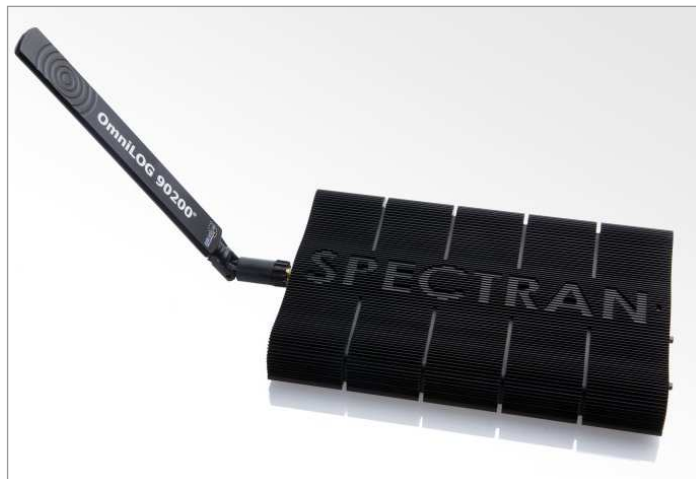
Der SPECTRAN ist auch als USB Desktop Version im vollgefrästen Aluminium Gehäuse verfügbar (Fernsteuerung per PC Analyse Software)
