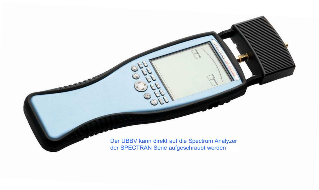
Der UBBV kann direkt auf die Spectrum Analyzer der SPECTRAN Serie aufgeschraubt werden
