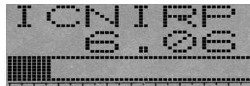
Die Grenzwertdarstellung erfolgt bei SPECTRAN® sowohl in Prozent als auch als Balkenanzeige.
