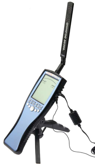
OmniLOG 90200 Antenne mit Spectran HF-60100 V4. Für die V4 Serie wird die Antenne direkt unterstützt. Für die Rev.3 Messgeräte für den GSM und UMTS Frequenzbereich eingesetzt werden (Messunsicherheit hier 2dB).
