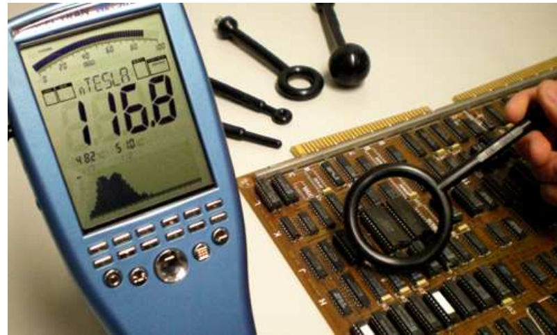
Magnetfeld-Messung an einer Baugruppe mit der 60mm H-Feld Sonde / Nahfeldsonde.
