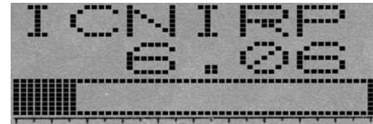
Die Grenzwertdarstellung erfolgt bei SPECTRAN ® sowohl in Prozent als auch als Balkenanzeige.
